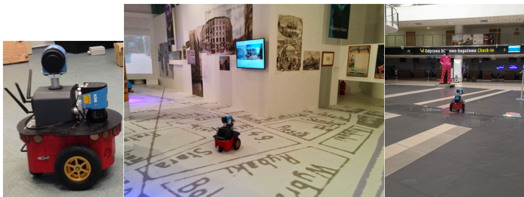
Rys. B.1: Prototyp autonomicznego robota mobilnego w zastosowaniu do poszukiwań potencjalnych obiektów niebezpiecznych (np. plecaki, bagaż podręczny) w budynkach infrastruktury krytycznej.
